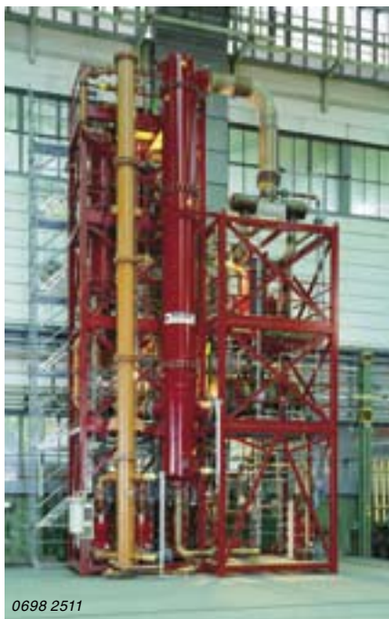
Ректификация с переменным давлением для производства чистого хлористого водорода без загрязнений побочными продуктами
